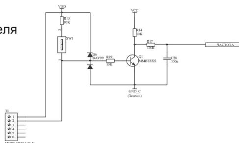
Схема соединений для частотного входа с сигналом напряжения
