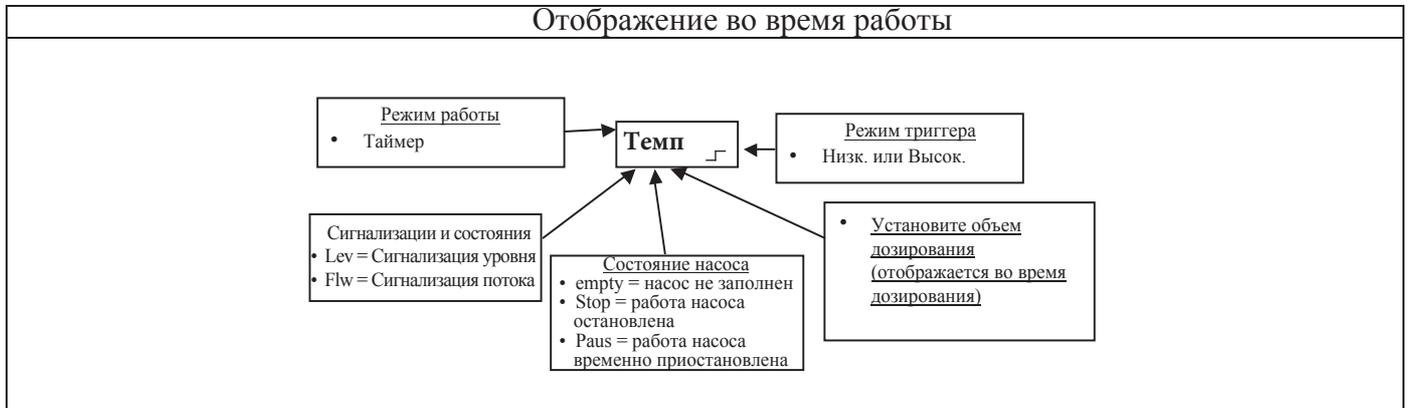
Параграф 8 - Дозирование по времени (**Входящий частотный сигнал "ТРИГГЕР" не активирован**)
