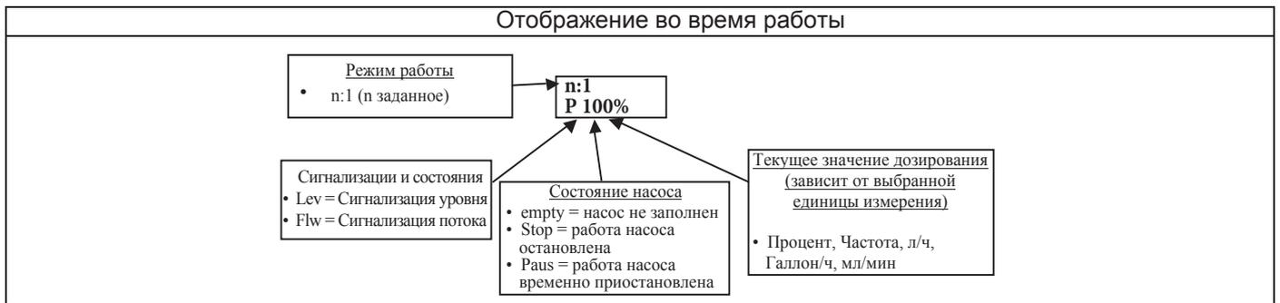
**Параграф 6 – Пропорционально внешним импульсам (пакетное дозирование)**
