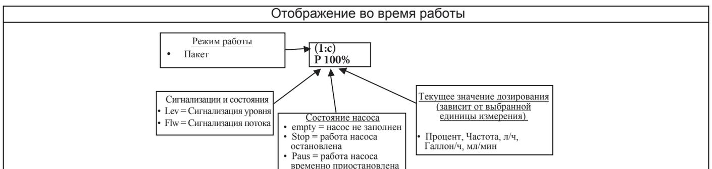
Параграф 7 – Пропорционально внешним импульсам (дозирование в мг/кг)
