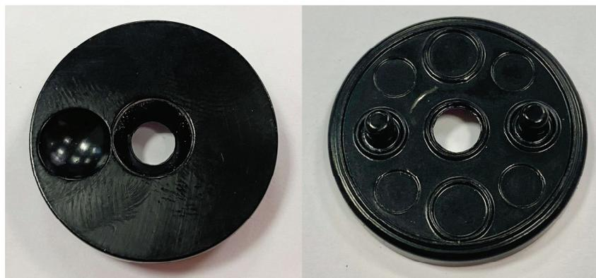
Поршневое кольцо LP12.20 из нового материала и новый фиксатор поршневого кольца LP12.20 используются в компрессорах с серийного номера 0919113232. Цилиндр LP12 (арт. 111497) не изменился, но может требовать замены при снижении производительности компрессора в связи с его износом.
