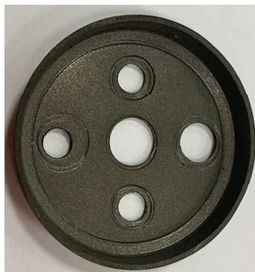
Одновременно с заменой материала поршневого кольца LP12.20 в компрессорах LP12 произошло изменение фиксатора поршневого кольца LP12.20 (арт. 112666), т.к. из-за увеличения толщины поршневого кольца LP12.20 уменьшилась толщина фиксатора поршневого кольца. Других конструктивных изменений фиксатора поршневого кольца не произошло.
