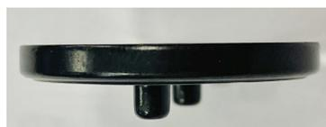
*Вид сверху и снизу нового и старого фиксаторов поршневого кольца различий не имеет.*
